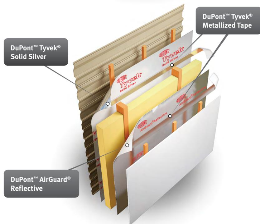
Пароизоляция AirGuard® Reflective укладывается с внутренней стороны утеплителя металлизированной поверхностью к воздушному зазору в сторону внутреннего помещения.
