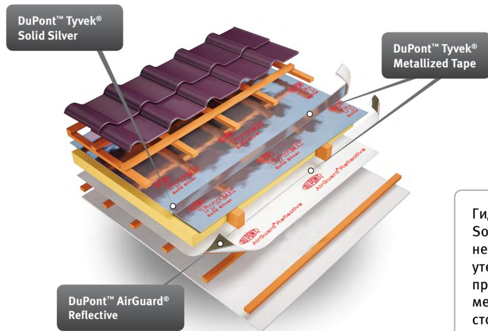
Гидроизоляция Tyvek® Solid Silver укладывается непосредственно на утеплитель с максимальным прилеганием, металлизированной стороной к вентилируемому зазору.
